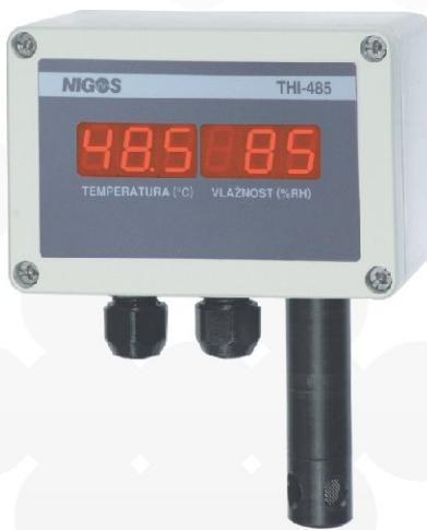
THI-485 es un indicador basado en microprocesadores diseñado para una medición precisa y visualización de temperatura y humedad relativa. Rango de medición de temperatura es de 0 - 50 °C o -40 - 80 °C, según el tipo de caja de la sonda. Precisión de la medición es 0.5 °C y la resolución 0.1 °C. Rango de medición de la humedad relativa es 0 - 100%, la precisión 2%RH con la resolución de 1% en la presentación y el 0.1% cuando se comunica a través del estándar EIA 485.
