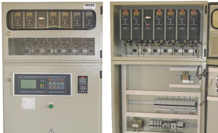
En el armario de control se encuentran los dispositivos y componentes para la gestión y protección de todos los equipos en el secador. El dispositivo más importante es el autómata para el proceso de secado y, dependiendo del tipo de secador, se localiza en el armario o junto a él.
