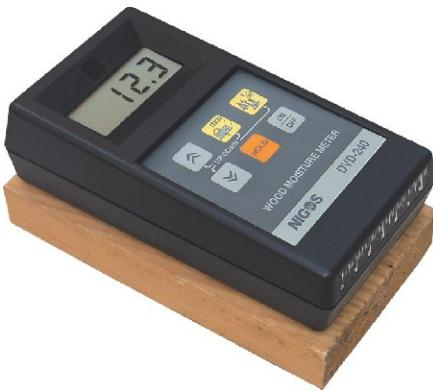
Medidor táctil de humedad DVD-240 está diseñado para la medición rápida del contenido de humedad de todas las especies de madera con sólo tocar la superficie plana de la tabla. No daña la superficie de madera y, también, se utiliza para medir la humedad en las chapas de madera. Cuenta con auto-calibración (ajuste de las condiciones actuales) y mide la humedad en el intervalo de 0 - 100%.
