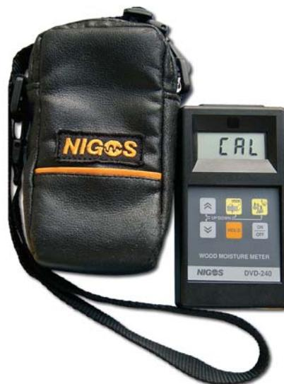
Dodirni merač vlage DVD-240 je namenjen za brzu proveru sadržaja vlage u drvetu. Omogućava merenje vlage u drvenim komadima većih ali i manjih debljina, sve do furnira. Merenje se obavlja jednostavnim prislanjanjem uređaja na ravnu drvenu površinu, uz prethodnu kratku pripremnu proceduru i podešenje parametara. Pritom, postupak merenja ne izaziva nikakva oštećenja merenog komada.
