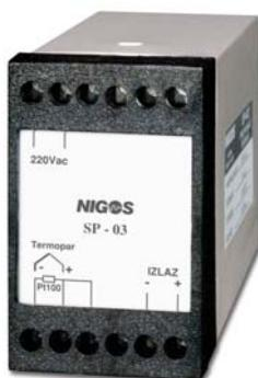
Transmiteri služe za pretvaranje signala sa temperturnih sondi u standardne strujne signale pogodne za merenje. Izlazni signal kod transmitera je proporcionalan merenoj temperaturi i postoji kompenzacija temperature slobodnih krajeva kod svih tipova termoparova.
